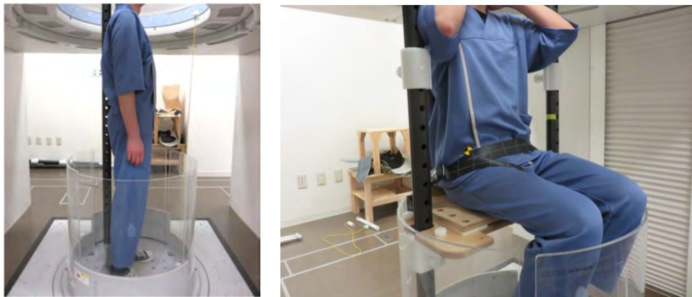
図 2.1 立位 CT による被験者の立位およびラップベルト着用時の座位計測
