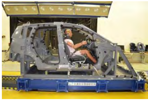
図 2.9 実験用スレッドと衝撃減速度 (50 km/h)
