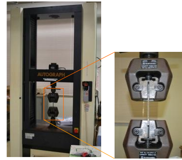
造形物における金属粉体の結合強さの測定
