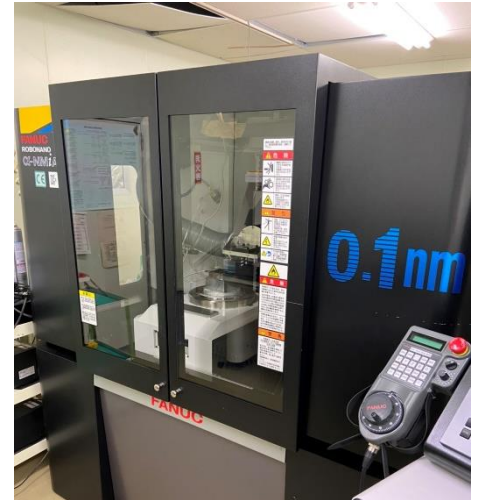
FANUC製 ロボナノ 分解能0.1nm 超精密加工に使用
