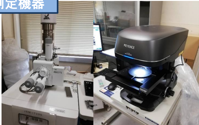
電子顕微鏡 & レーザ顕微鏡 社本研究室専用の顕微鏡！
