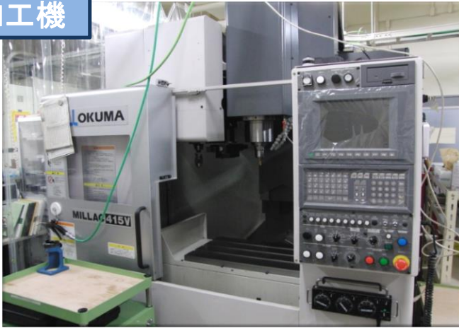
オークマ製 立形マシニングセンタ 重切削での実験や治具製作に使用
